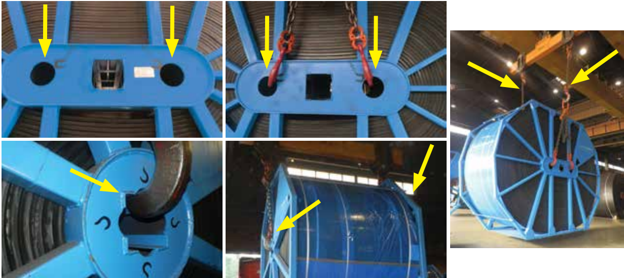
Рисунок 3: Открытые эллиптические катушки и открытые стальные катушки - рекомендуемый способ подъема рулона с использованием подходящего подъемного оборудования (минимальное требование: чалка).
