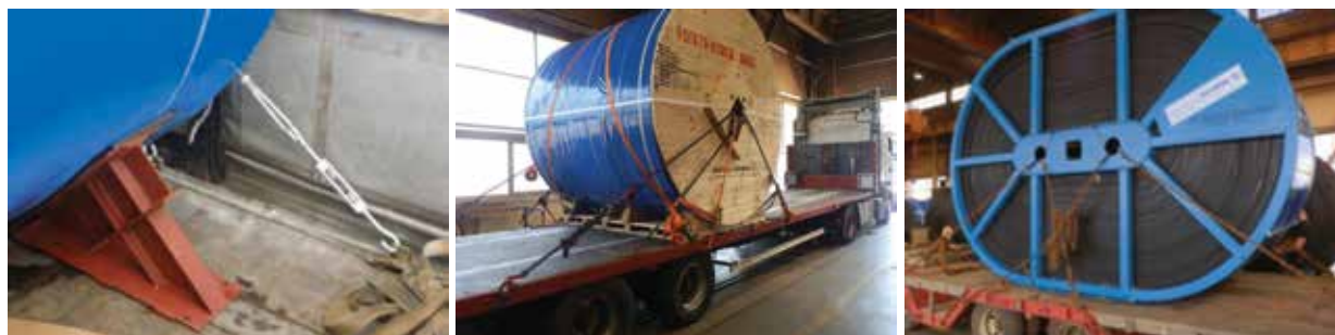
Рисунок 5: Рекомендуемый способ обеспечения безопасности и тщательной защиты барабанов перед транспортировкой
