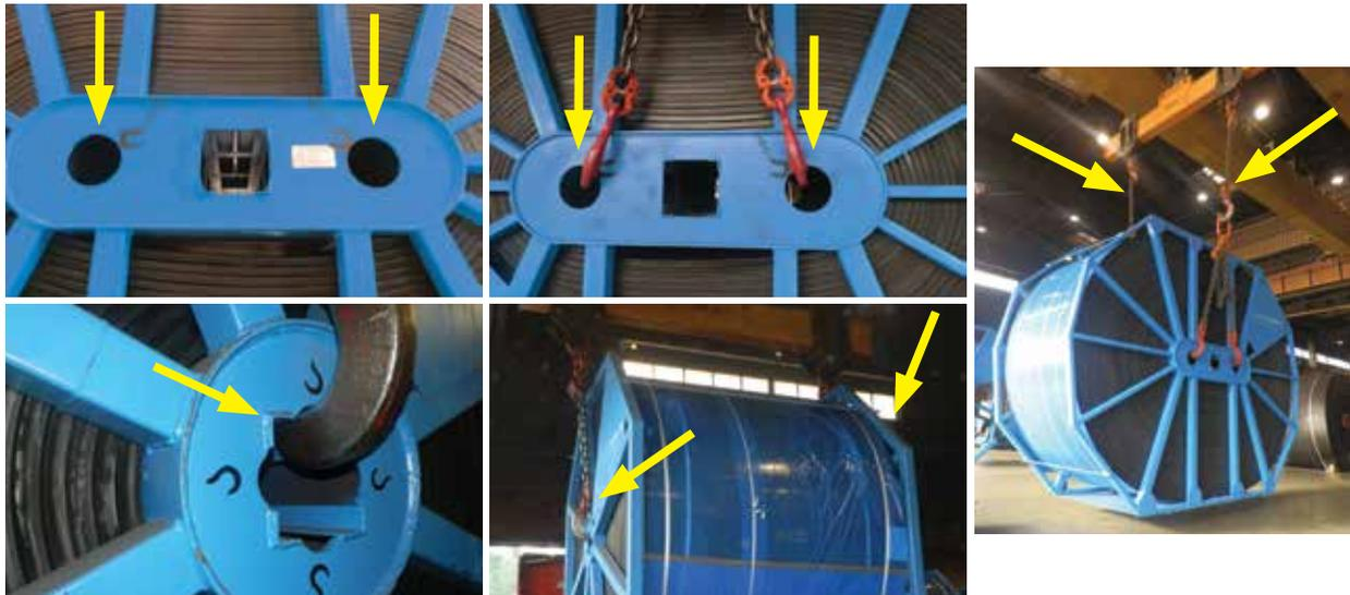
**Fig. 3: Contenedores de plataformas con laterales de elipse abierta et carretes abiertos de acero – método recomendado de levantar el rollo usando equipo de elevación adecuado (una cadena de suspensión es el requisito mínimo).**
