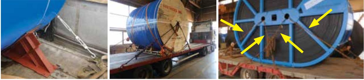
**Fig. 5: Método recomendado de asegurar la seguridad y la protección cuidadosa de los carretes antes del transporte**
