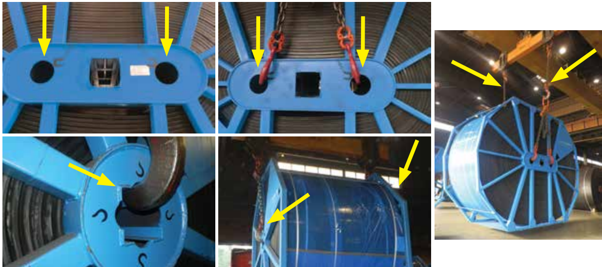
Fig. 3 : Touret en ellipse et emballage en ellipse – méthode recommandée pour lever le rouleau en utilisant un équipement de levage approprié (une élingue de levage est un minimum nécessaire).
