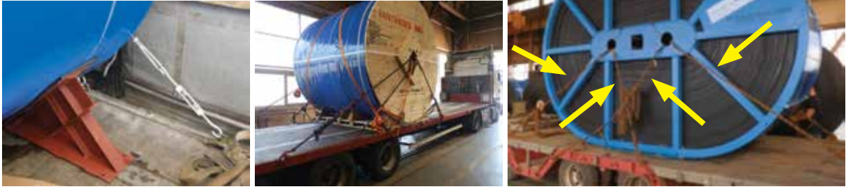
Fig. 5: Méthode recommandée pour assurer une protection méticuleuse et sûre des bobines avant le transport
