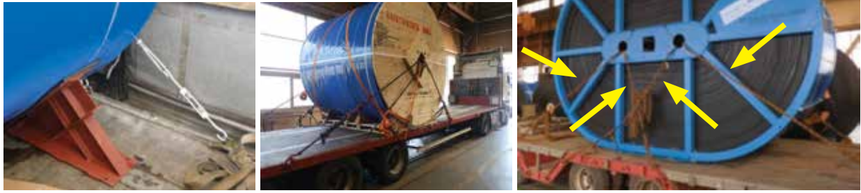
Ilustracja 5: Zalecany sposób zapewnienia bezpieczeństwa i dokładnej ochrony szpul przed transportem
