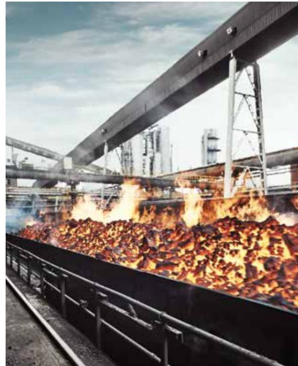
**S:** Carcasa y revestimiento ignífugo según la norma ISO 340, antiestático según la norma ISO 284. Para uso general con requisitos de seguridad en materia de electricidad e incendios de acuerdo con la norma EN 12882 y el antiguo tipo alemán S definido en la norma DIN 22102.
