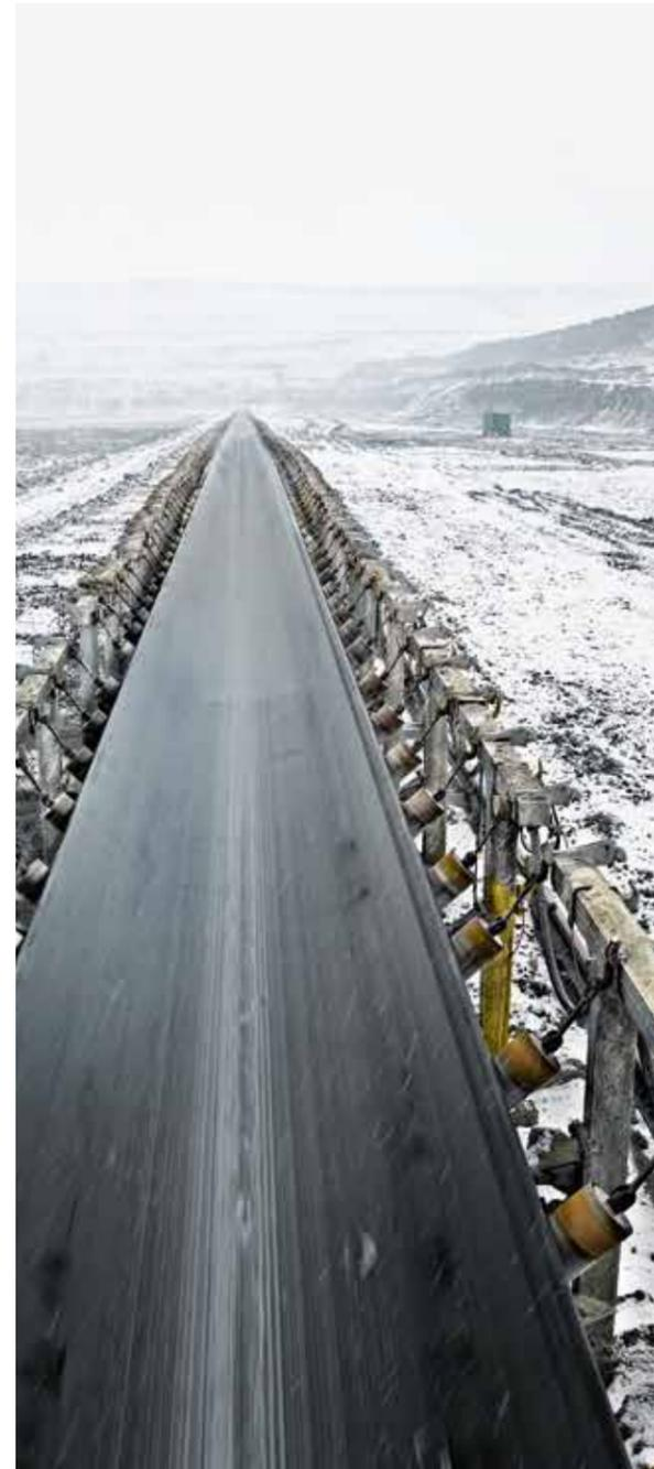
En algunas regiones, las bandas transportadoras quedan expuestas a intervalos de temperatura muy amplios. La estructura de la banda puede volverse frágil e incluso agrietarse con temperaturas por debajo de -30 °C.
