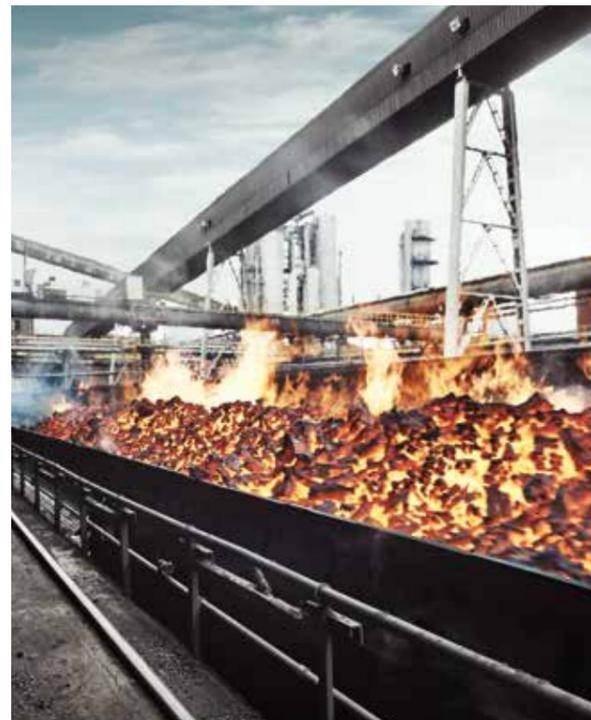
**S:** revêtement et carcasse ignifuges selon la norme ISO 340, antistatique selon la norme ISO 284. Pour utilisation générale avec exigences de sécurité électrique et incendie conformes à la norme EN 12882 et à l'ancienne qualité allemande S définie dans la norme DIN 22102.
