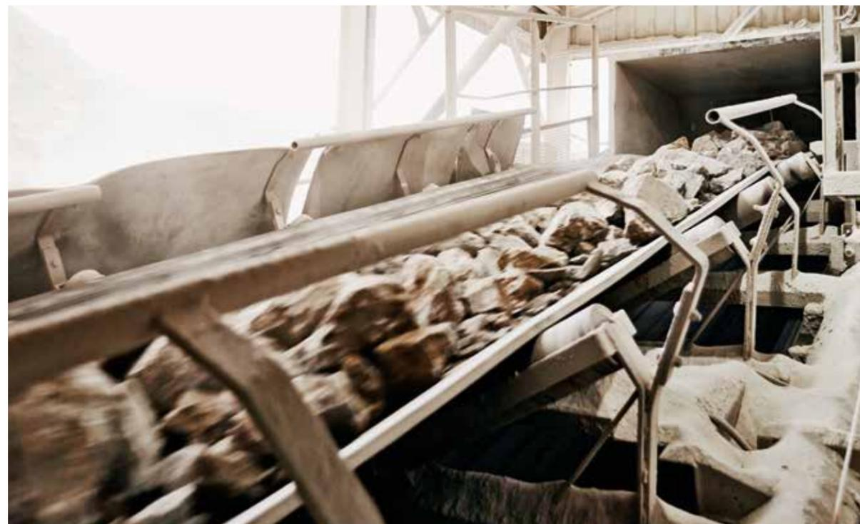
La gamme Ripstop comprend plusieurs constructions permettant une protection sur mesure de votre bande contre les chocs, les perforations et les coupures. Les
