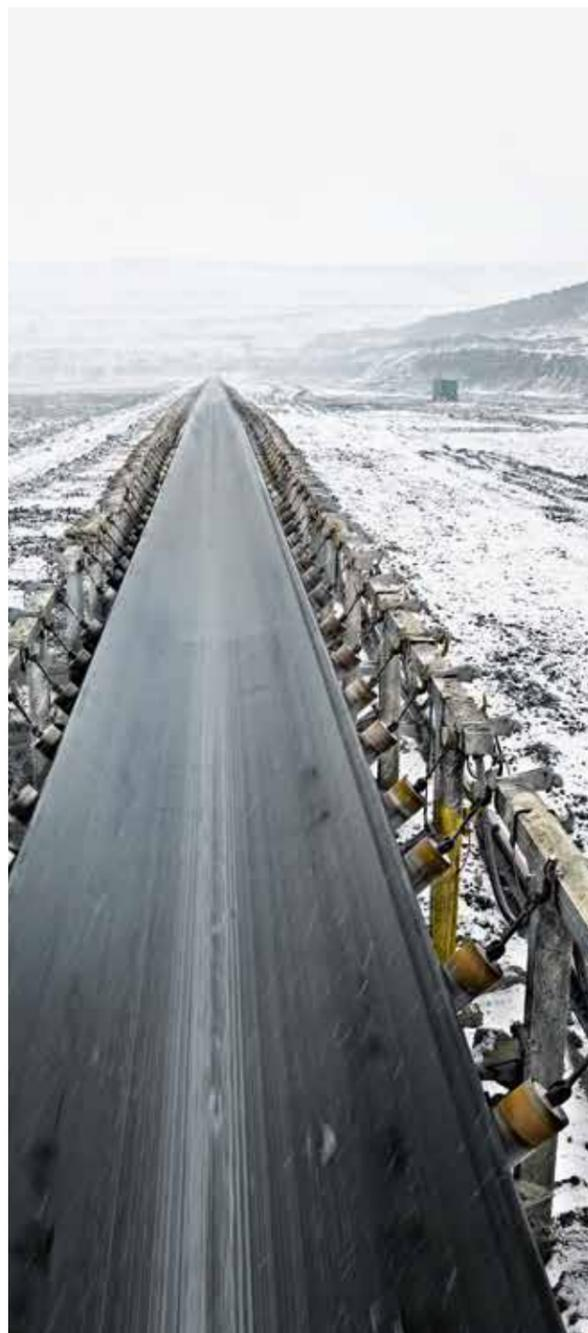
Dans certaines régions, les bandes transporteuses sont exposées à des amplitudes thermiques considérables. La structure de la bande peut devenir cassante et être susceptible de se fissurer à des températures inférieures à -30 °C.
