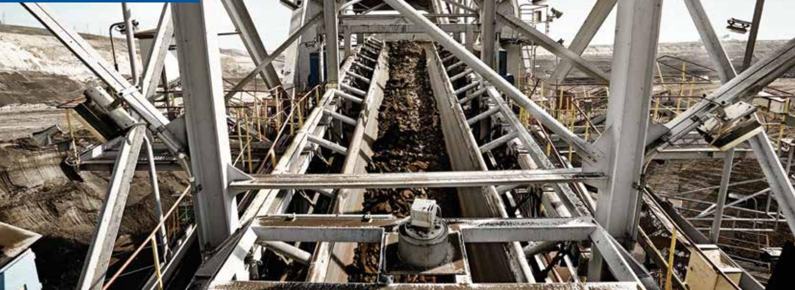
La gamme Ripstop™ englobe plusieurs avantages, offrant une protection de votre bande sur mesure contre les chocs, les perforations et les coupures. Les bandes Ripstop sont basées sur la carcasse en acier Multitrans ou Sempercord. Elles sont disponibles en option textile ou métal.
